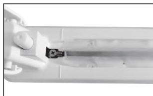
⑤ 将新的电热丝一端与导电件锁紧
