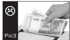
> angan menaruh uang kertas yang cacat, terlipat, atau rusak parah pada tempat pemasukan mesin.
